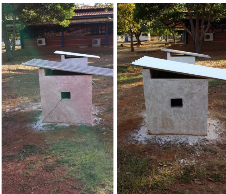
Figura 11 - Modelos após a raspagem de revestimento
