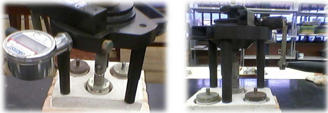
Figura 13: Esforço de tração aplicado com o dinamômetro.
