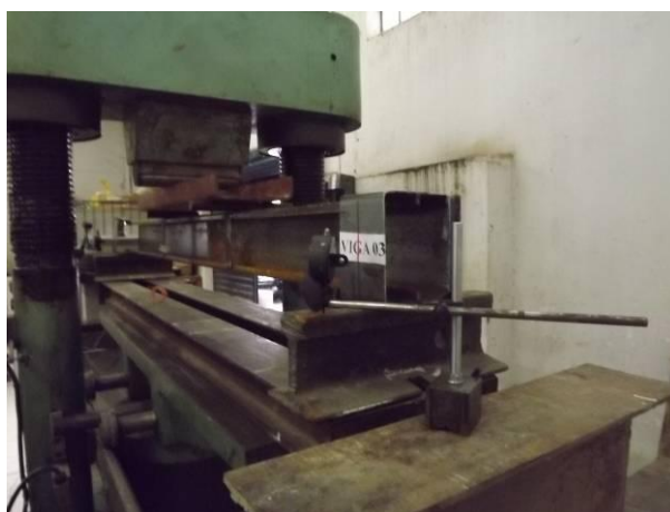
Figura 5.6 – Viga 03 com solda executada com amperagem baixa.
