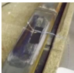
Figura 4.16 – Proteção mecânica dos extensômetros.
