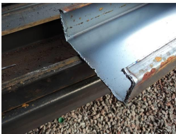
Figura 4.7 – Corte feito com maçarico.
