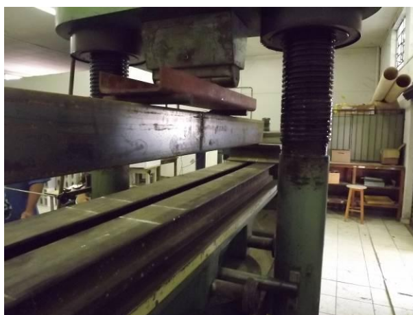
Figura 4.11 – Pontos de aplicação de carga superior.
