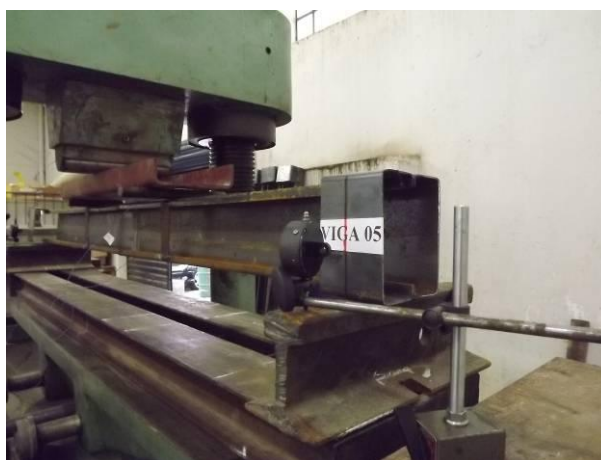
Figura 5.10 – Viga 05 com solda executada com eletrodo úmido.
