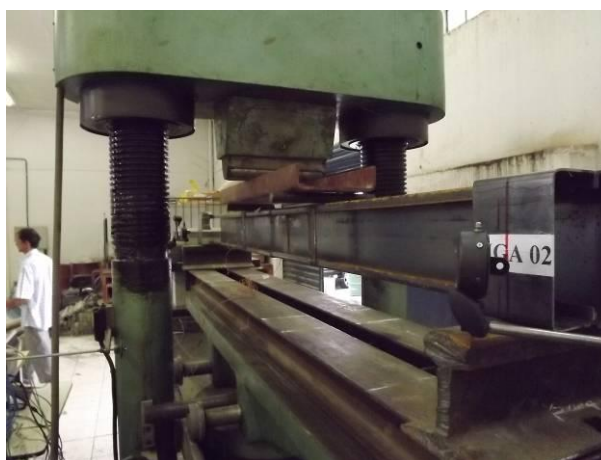
Figura 5.4 – Viga 02 com solda executada com amperagem alta.
