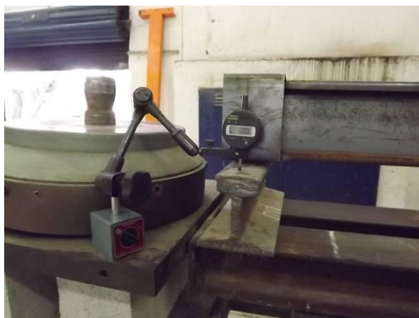
Figura 4.13 – Posicionamento dos deflectômetros.
