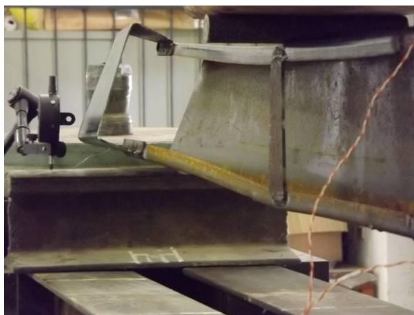
Figura 6.1 – Flambagem lateral por torção.
