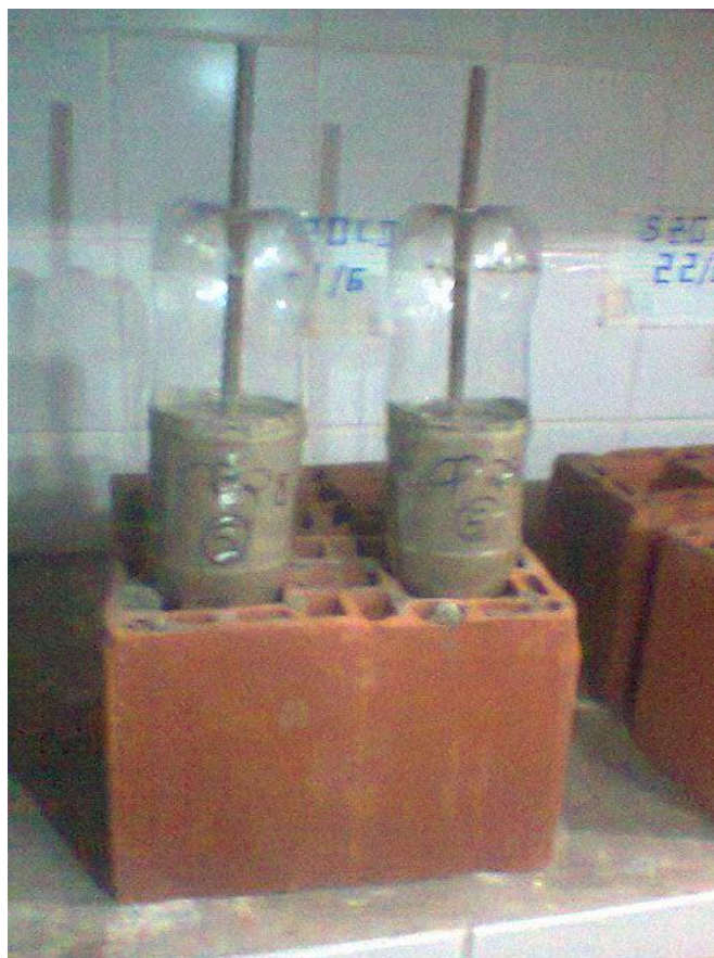
Figura 10: Cura dos corpos-de-prova Fonte: Autores
