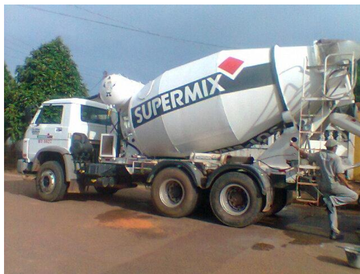
Figura 6: Mistura do Concreto no Caminha Betoneira Fonte: Autores.
