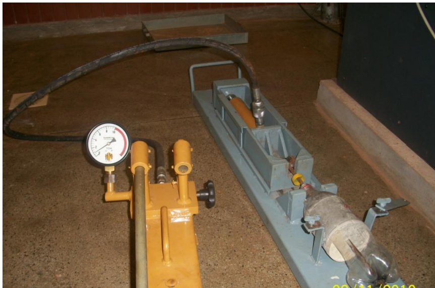
Figura 11: Ensaio de arrancamento Fonte: Autores.
