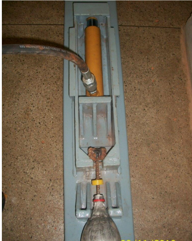
Figura 15: Ensaio de arracamento Fonte: Autores
