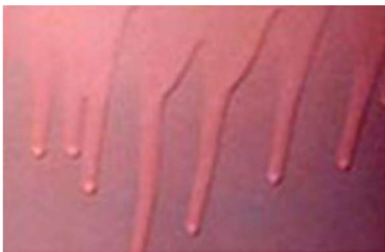
Figura 5.61 – Escorrimento da tinta. Fonte: http://www.globalcolor.com.br/probl_escorr.jpg .
