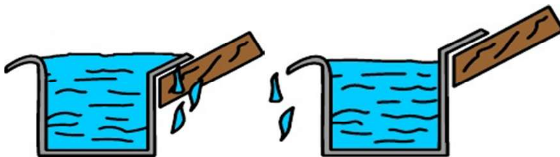
Figura 5.50 – Calha mal projetada.
