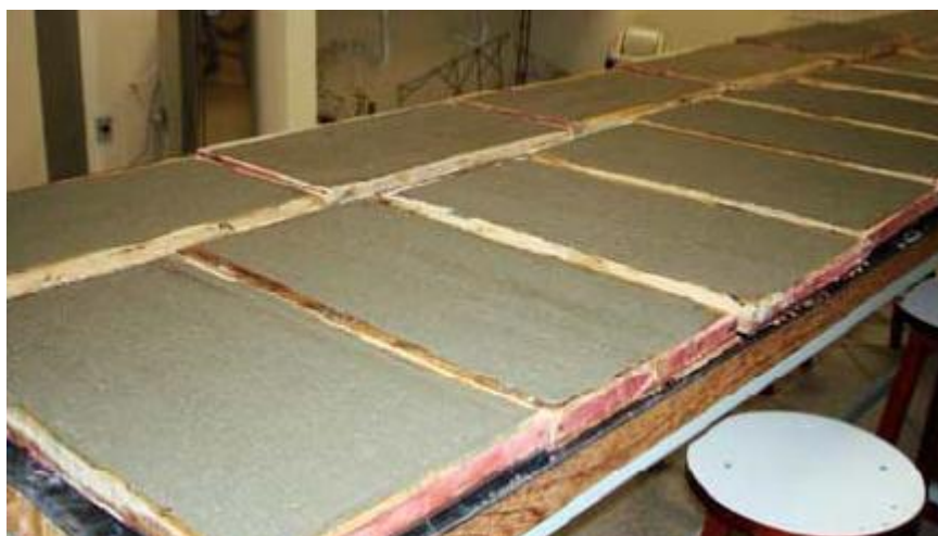
Figura 6.4 – Substratos-padrão concretados (SALLES NETO, 2009).
