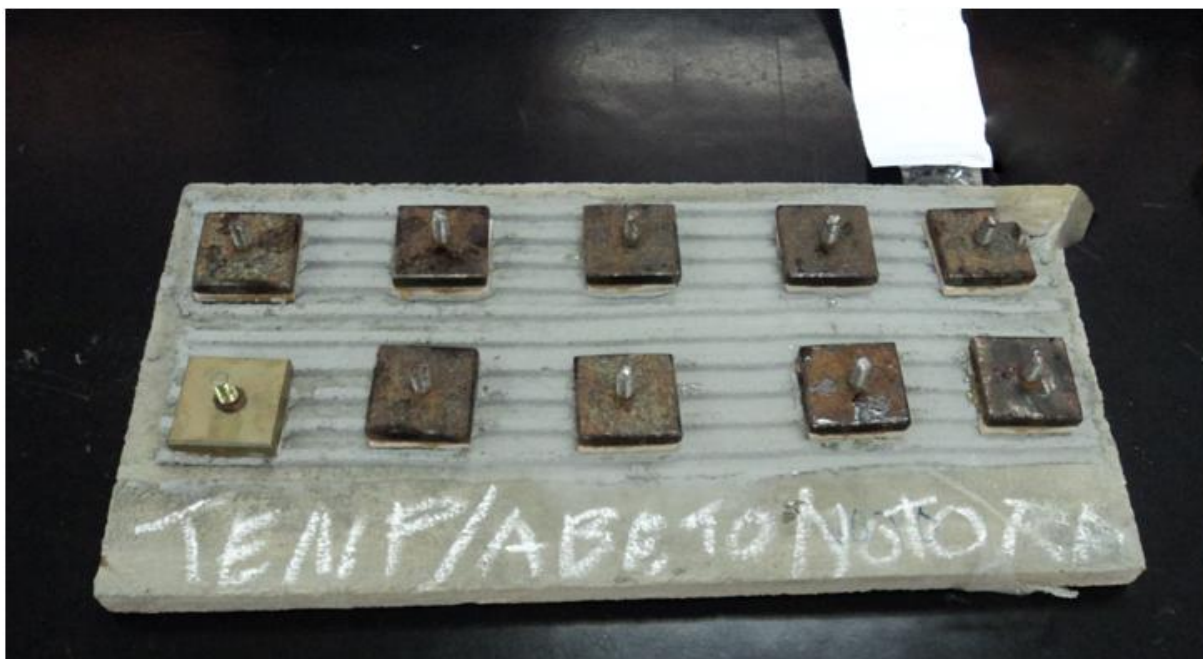
Figura 6.11 – Colagem das peças metálicas para o ensaio de arrancamento.
