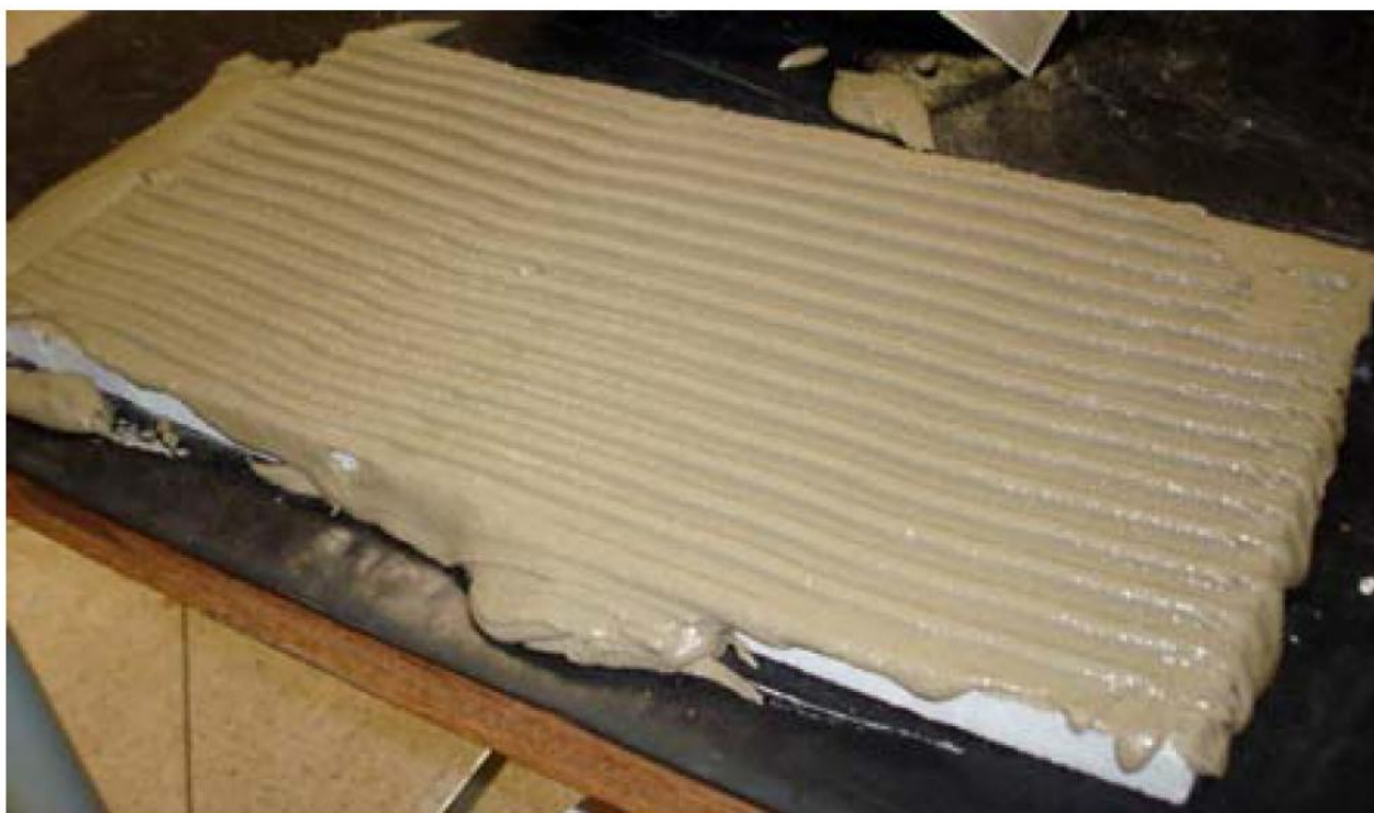
Figura 6.6 – Formação de cordões sobre o substrato já imprimados (SALLES NETO, 2009).
