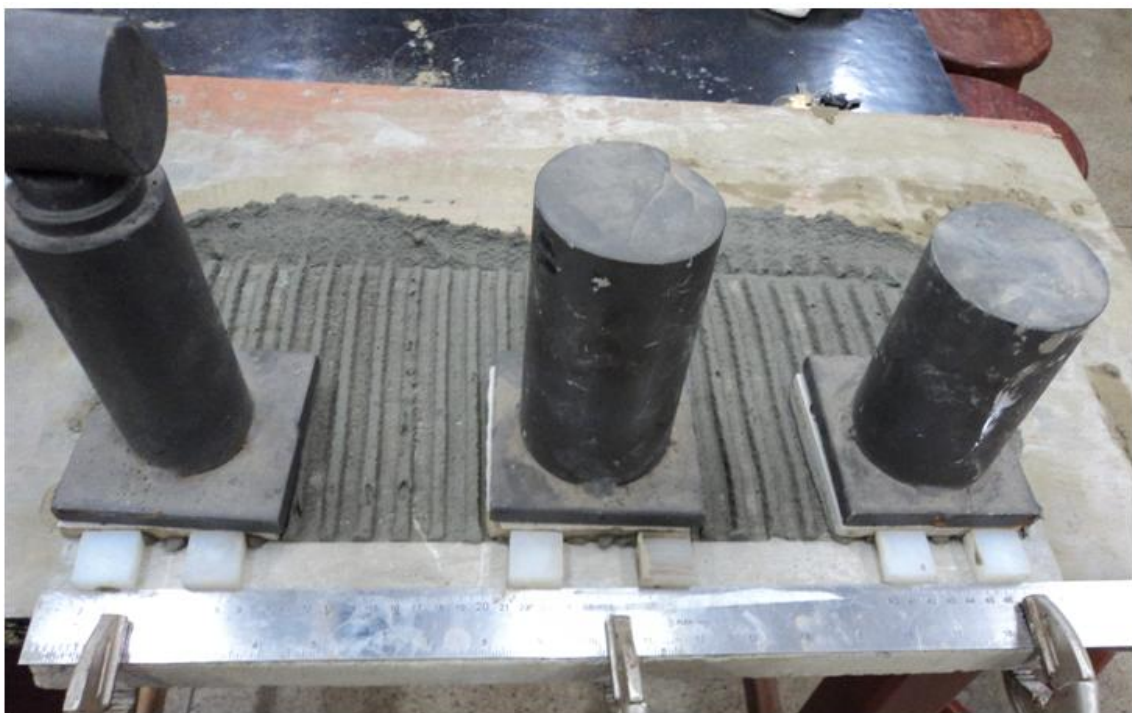
Figura 6.19 - Carregamento das placas com a massa padrão de 5 kg.
