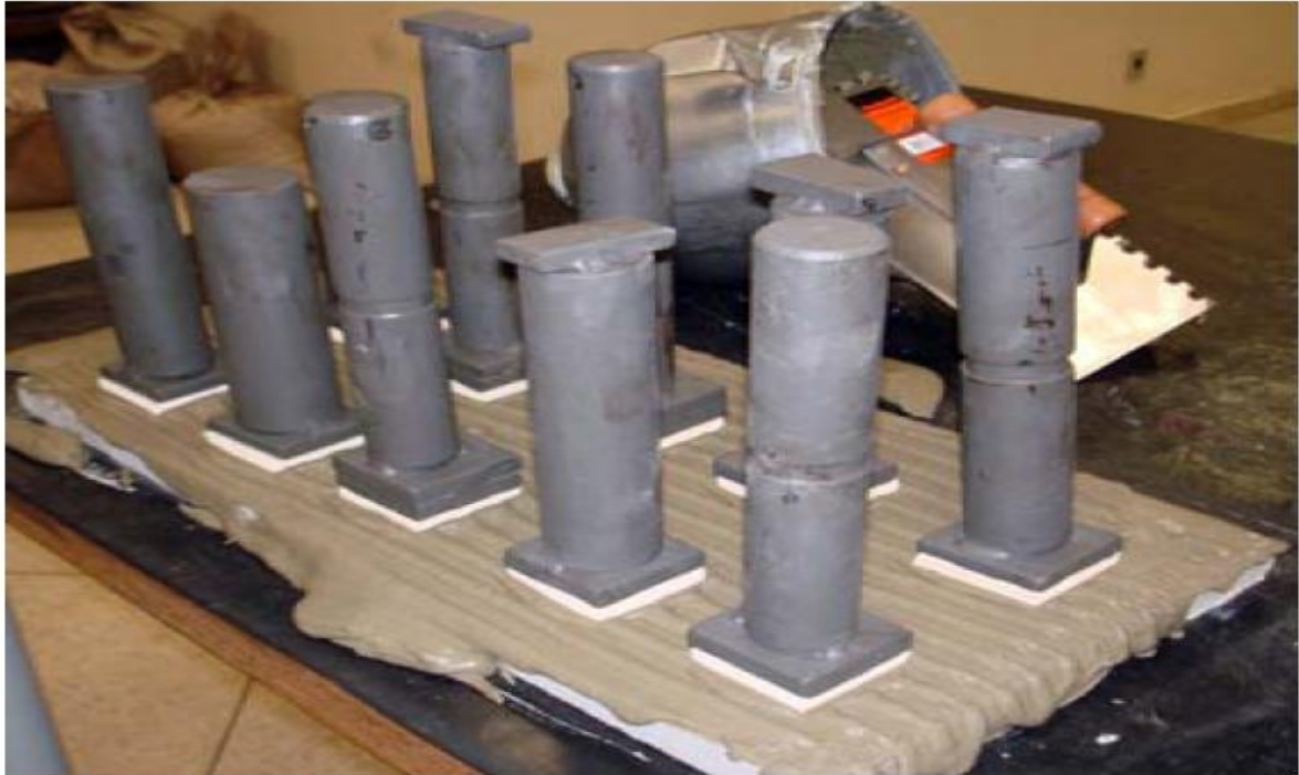
Figura 6.7 – Carregamento das placas cerâmicas com a massa padrão de 2 kg (SALLES NETO, 2009).
