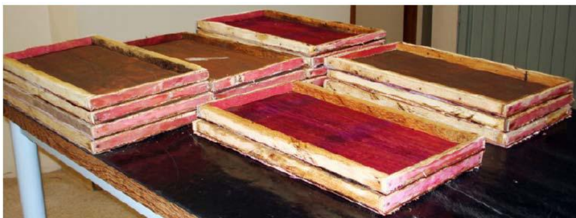
Figura 6.1 - Formas de compensado empregadas na confecção dos substratos-padrão (SALLES NETO, 2009).
