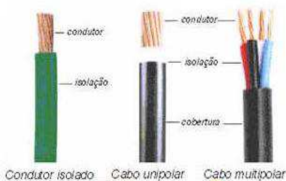
Figura 2: Tipos de condutores (Fonte: Redes Elétricas)
