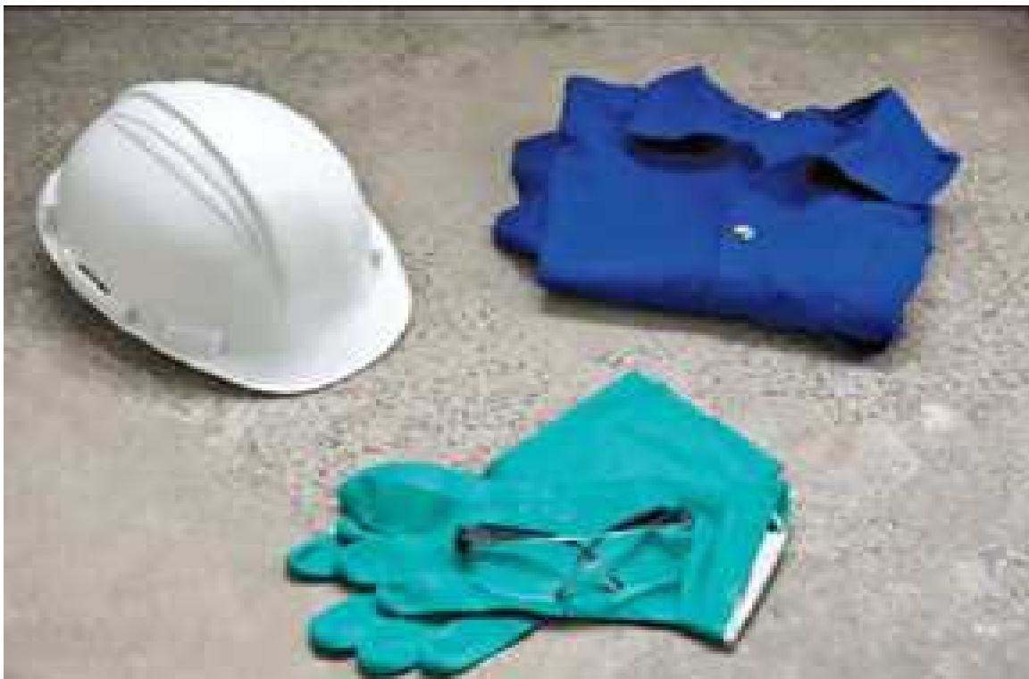
Figura 10 - . EPIs necessários para a execução da impermeabilização (Fonte: revista Técnica)
