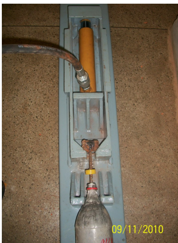
Figura 16: Ensaio de arracamento Fonte: Autores
