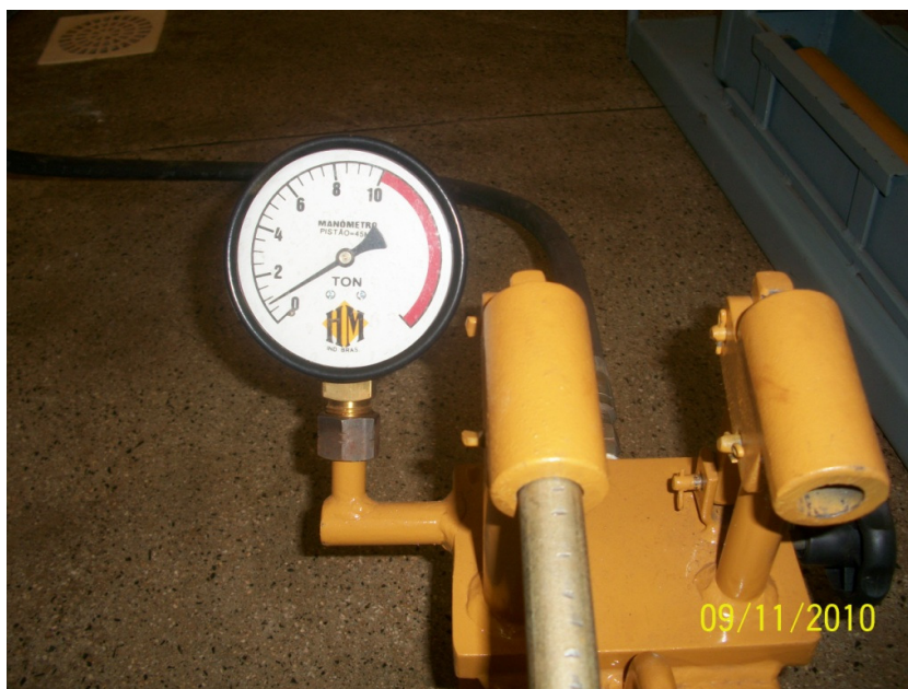
Figura 13: Detalhe do macaco hidráulico Fonte: Autores
