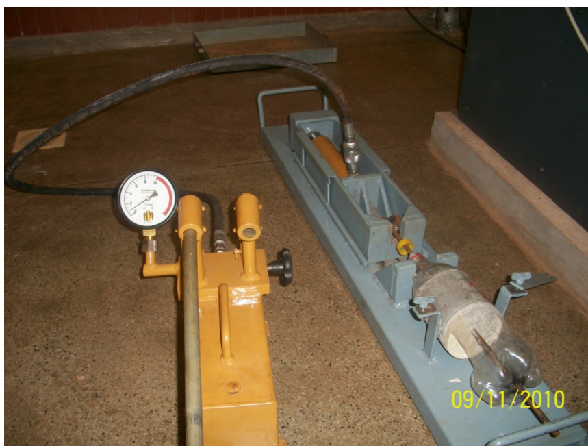
Figura 12: Ensaio de arrancamento Fonte: Autores.
