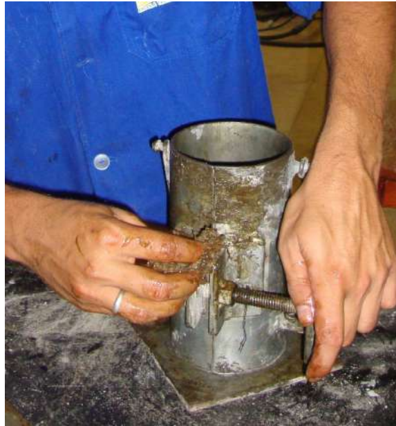
Figura 3.15 – Preparação dos corpos-de-prova
