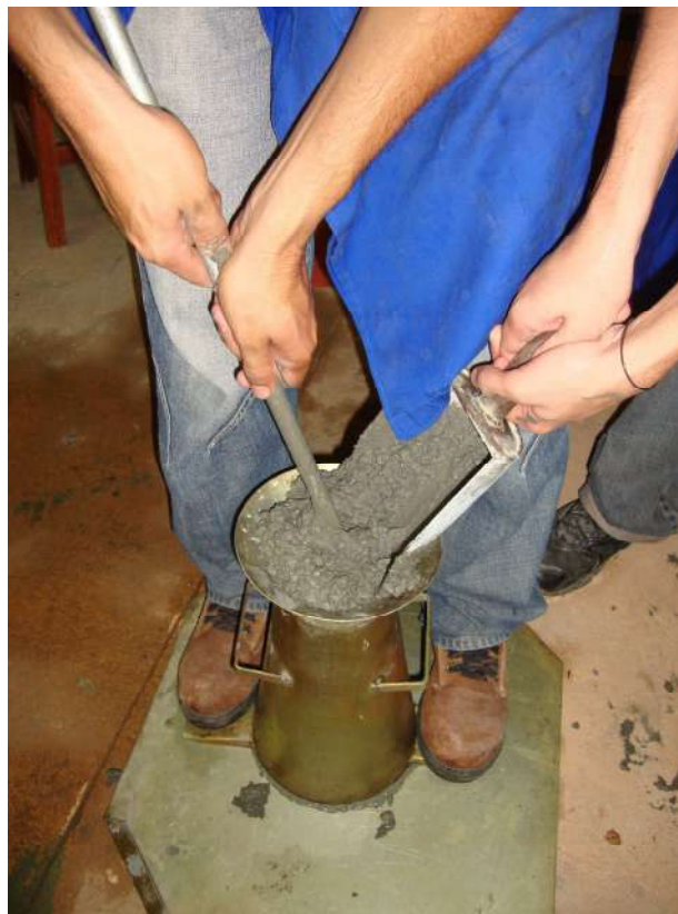
Figura 3.11 – Terceiro passo do ensaio de abatimento do troco de cone
