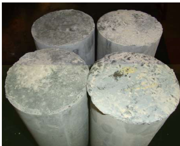
Figura 3.18 – Superfície irregular dos corpos-de-prova
