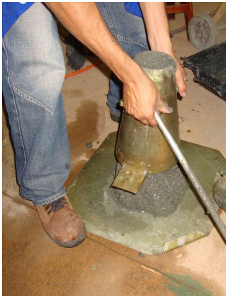
Figura 3.12 – Quarto passo do ensaio de abatimento do troco de cone
