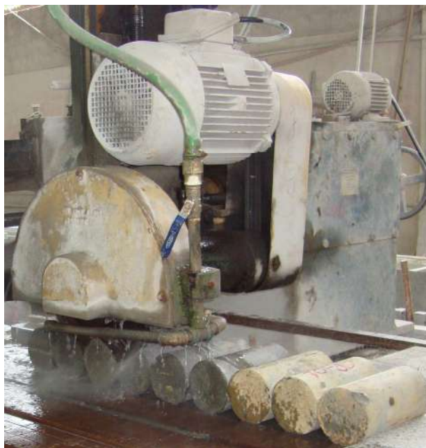
Figura 3.19 – Torneamento dos corpos-de-prova
