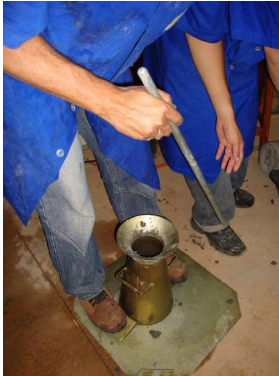
Figura 3.9 – Primeiro passo do ensaio de abatimento do troco de cone
