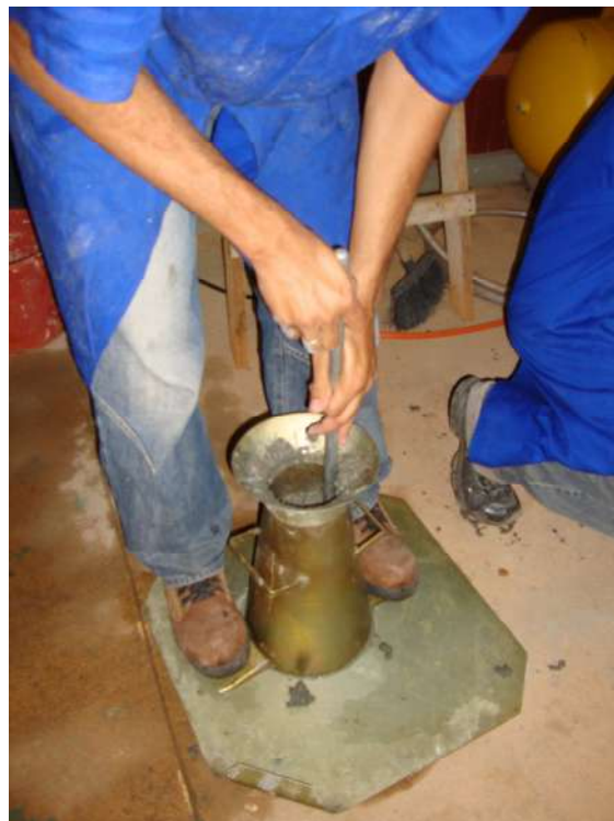
Figura 3.10 – Segundo passo do ensaio de abatimento do troco de cone
