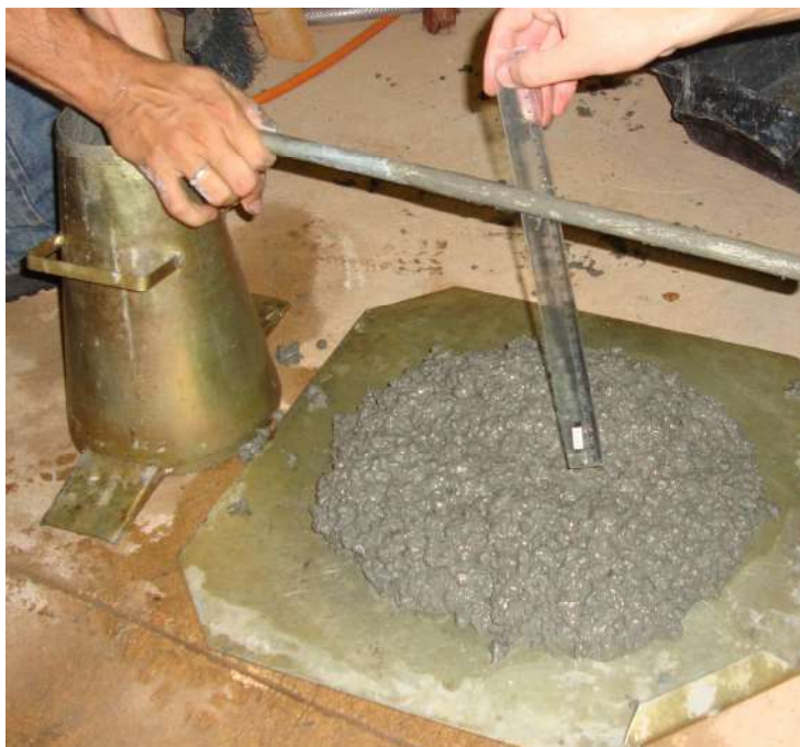
Figura 3.13 – Quinto passo do ensaio de abatimento do troco de cone
