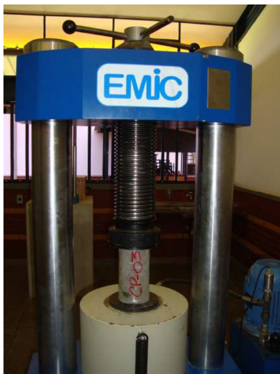
Figura 3.21 – Ensaio de Resistência à Compressão
