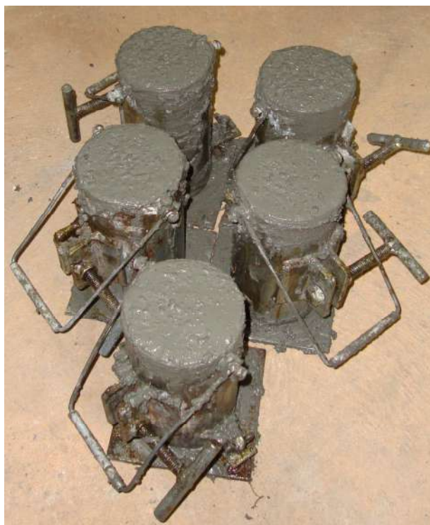
Figura 3.14 – Moldagem dos corpos-de-prova
