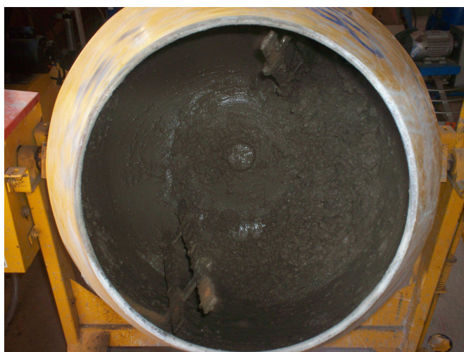
Figura 6: Mistura dos materiais na betoneira. Fonte: Autores.
