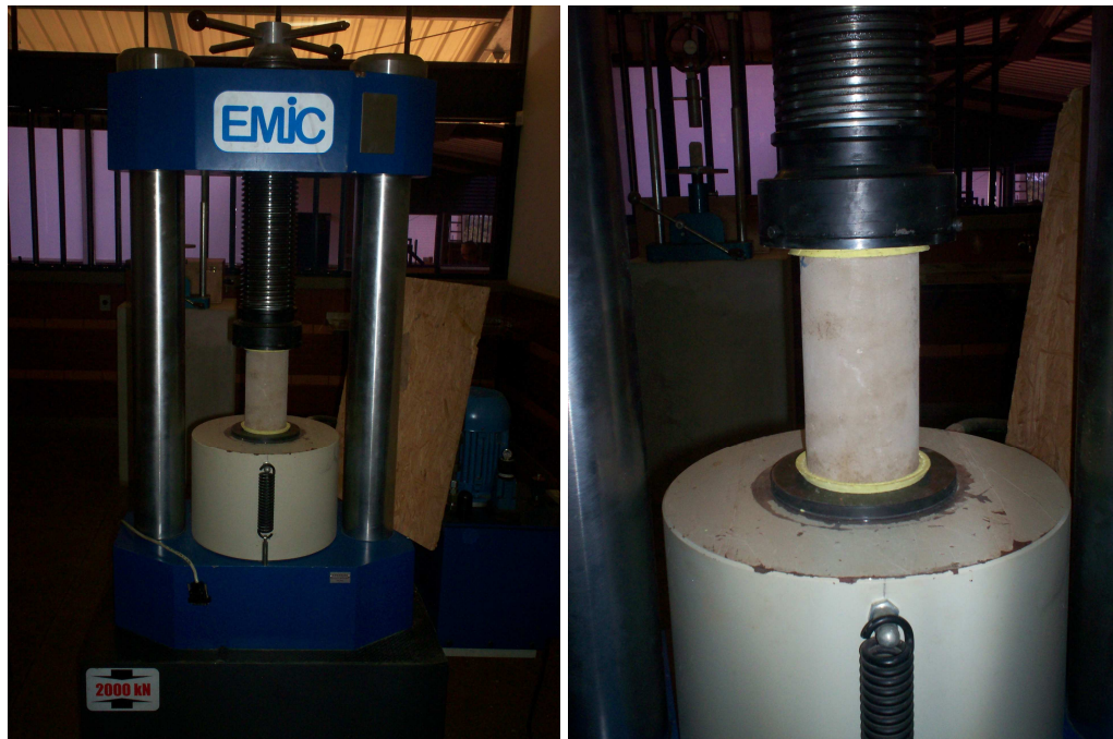
Figura 11: Ensaio de resistência à compressão. Fonte: Autores.
