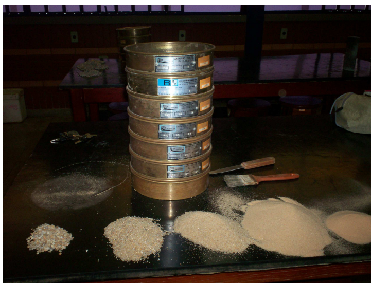
Figura 18: Procedimento executado para realização do ensaio. Fonte: Autores.
