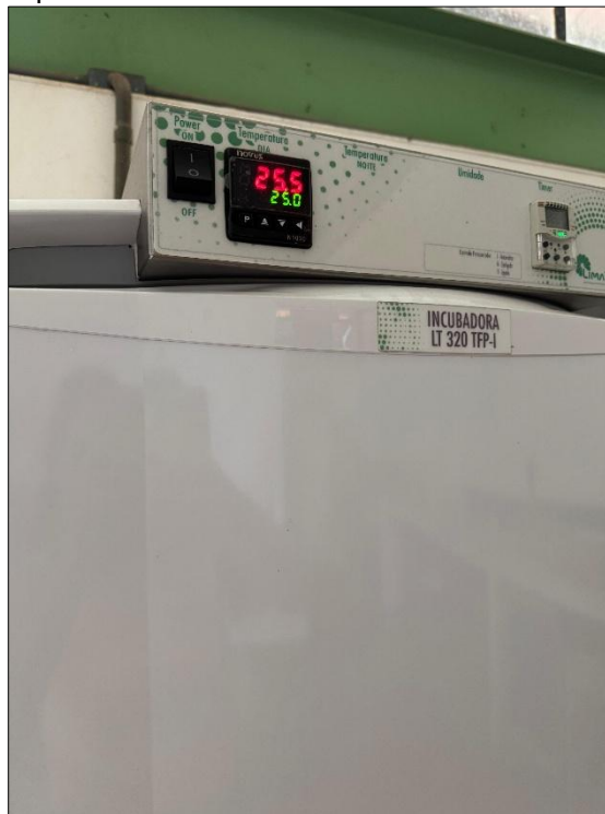
Foto 12 – Temperatura controlada a 25 °C na câmara de germinação Tipo B.O.D para experimento
