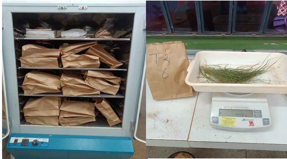
Figuras 9 e 10. Material coletado das parcelas secando em estufa de ventilação forçada a 65 °C por 48 horas dia 28/04/2025, e pesagem após 48 horas de secagem em estufa dia 30/04/2025.
