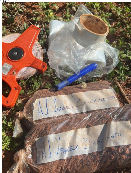
Figura 5 - Materiais utilizados para acondicionar o solo e identificar as respectivas áreas, parcelas e lançamentos da amostragem.
