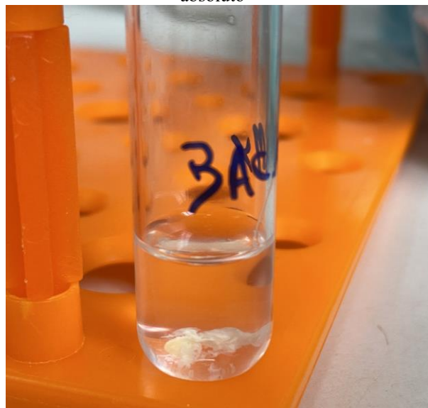
Figura 7 – Produção de precipitado em etanol absoluto
