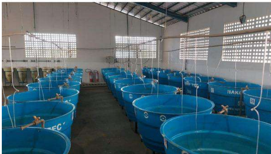
Figura 6 — Sistema de produção de tambaqui em caixas de PVC 500L e oxigenação controlada
