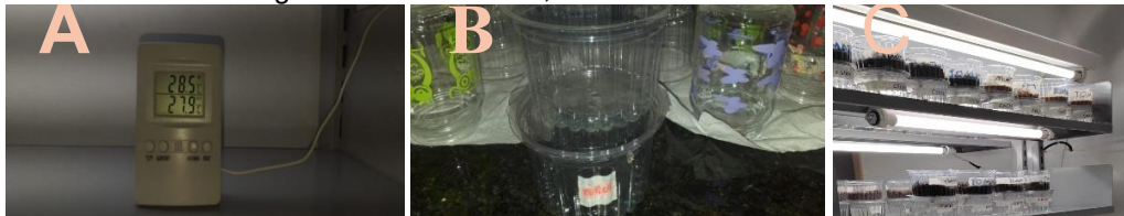
Figura 4 - preparo do material para os ensaios ecotoxicológicos com plantas, sendo: A. Termômetro digital, B. recipientes descartáveis identificados, C. prateleiras energizadas, ar-condicionado, no Laboratório de Ecotoxicologia do IFTO/ Palmas, Tocantins/ Brasil.
