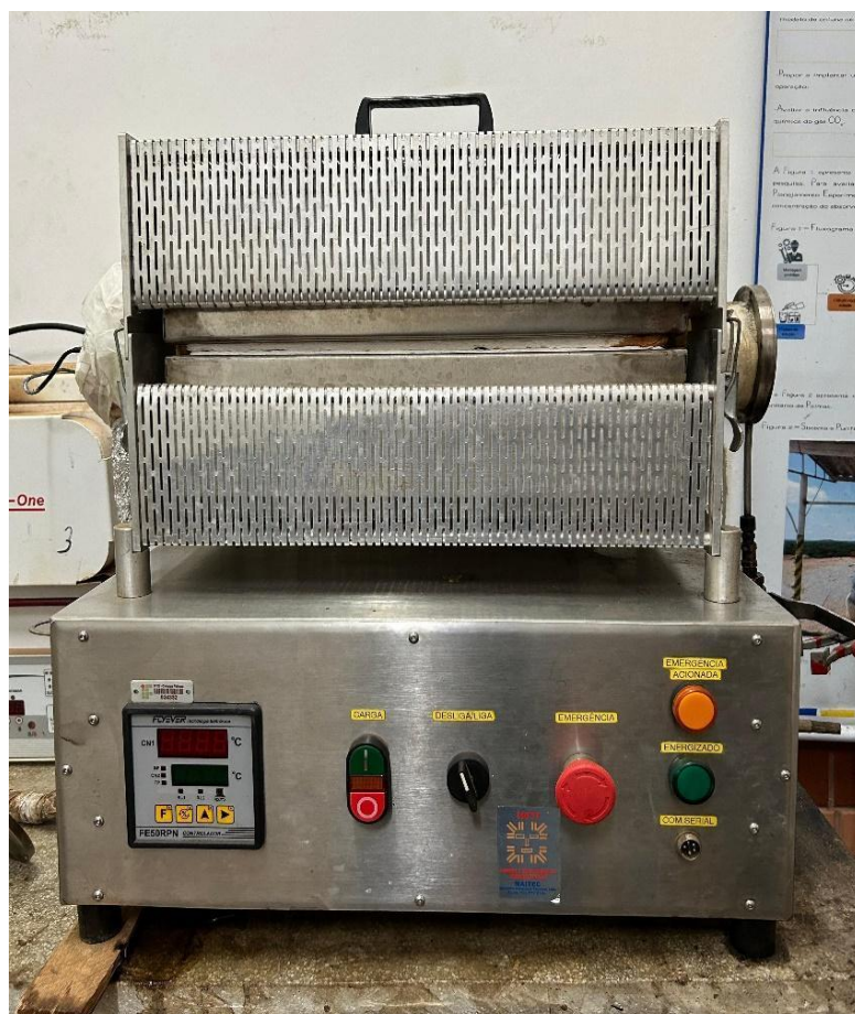
Figura 9 - Reator termoeletrico utilizado no processo de pirólise
