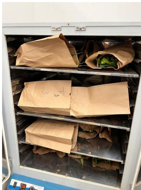
Figura 8. Material coletado das parcelas secando em estufa de ventilação forçada à 65°C por 48 horas.
