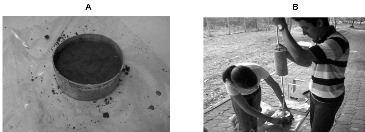
Figura 2. Foto 2º anel compactado (A) e Solo sendo compactado no anel (B).
