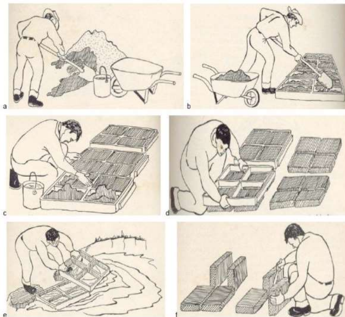
Figura 3: Processo de fabricação do adobe.
