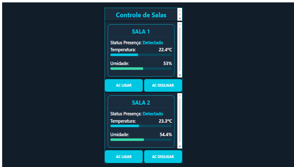
Figura 3: Dashboard para controle e monitoramento do ar-condicionado em tempo real.
