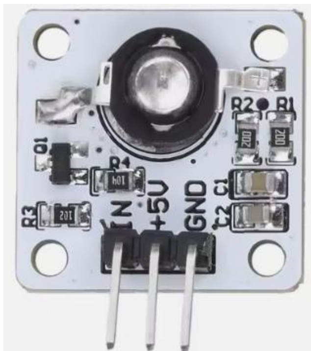
Figura 5- Módulo Transmissor Infravermelho de Alta Potência
