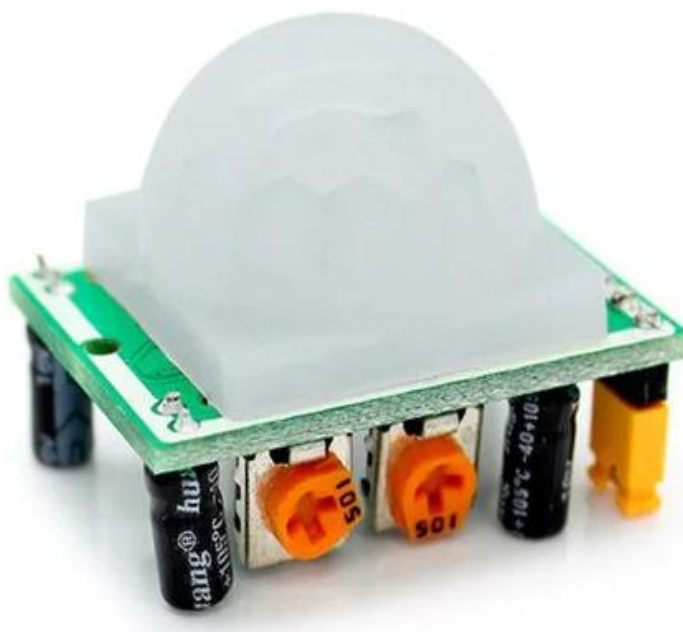
Figura 4 – Sensor de Movimento Presença PIR HC-SR501
