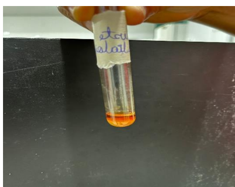
Figura 8 - Teste de verificação de Alcaloides (coloração castanho amarelado indicativa de reação positiva).
