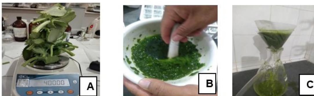
Figura 2 – (A) Pesagem das folhas do aranto, (B) Maceração das folhas do aranto, (C) filtragem à vácuo das folhas para obtenção do extrato.
