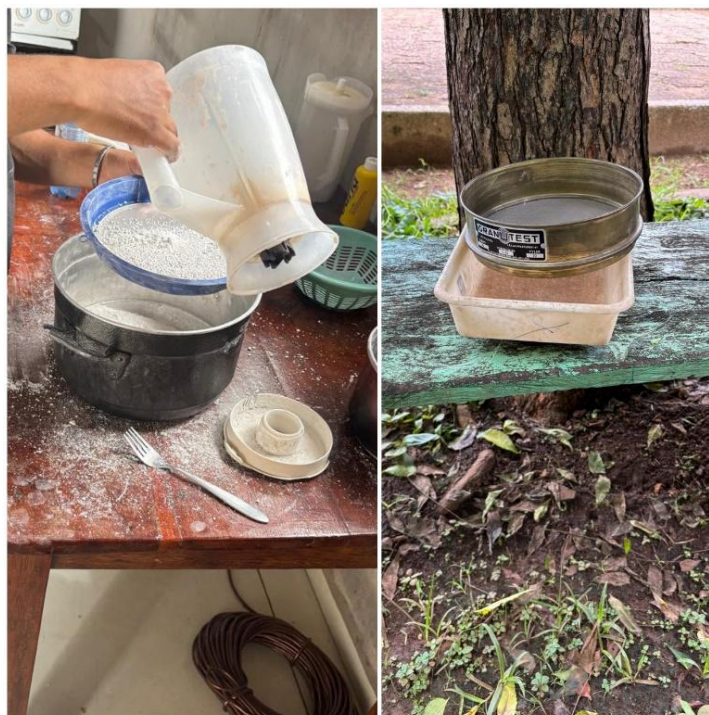
Figura 3 - Processo de padronização do gesso (destorroamento e peneiramento)
