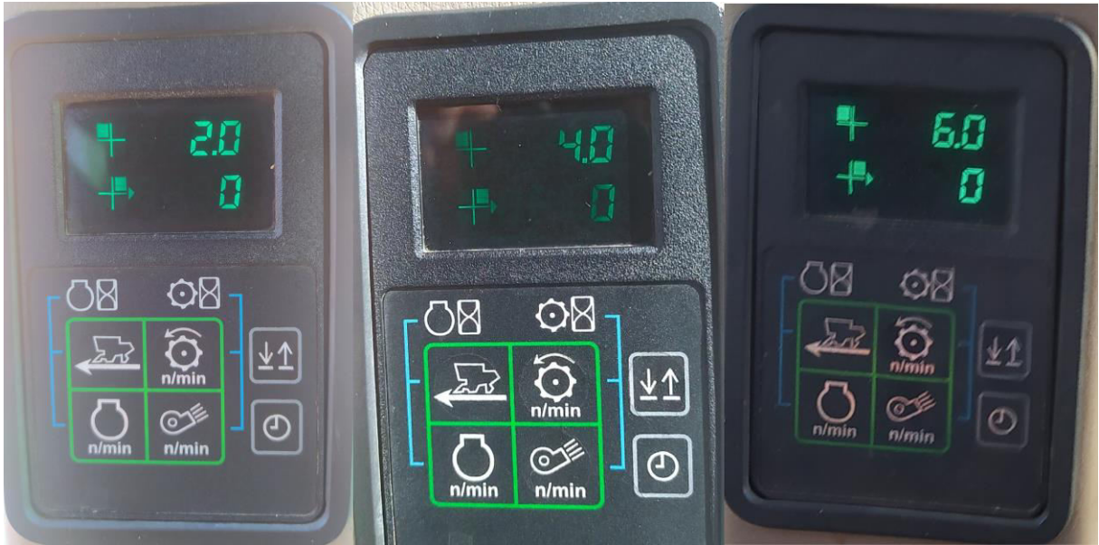
Figura 5. Velocidades de deslocamento da colhedora, 2, 4 e 6 km.h-1.
