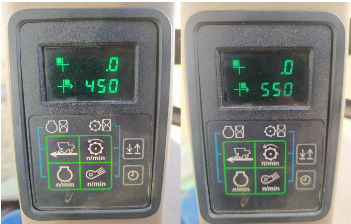
Figura 6. Diferentes rotações do cilindro de trilha, 450 e 550 rpm.
