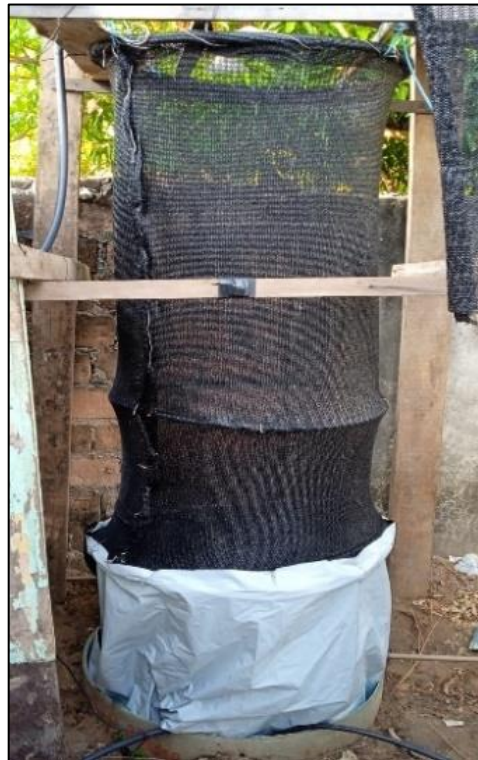
Figura 4 – Torre de resfriamento
