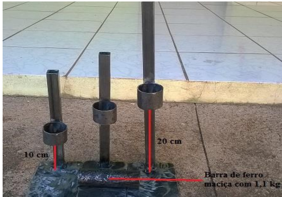
FIGURA 1: Estruturas metálicas utilizadas para causar impacto sobre os diásporos de teca ( Tectona grandis L.f.).
