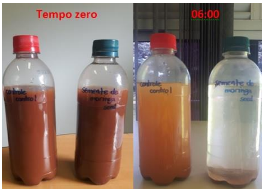
Figura 6 - Comparativo de amostras de água com e sem semente de moringa.
